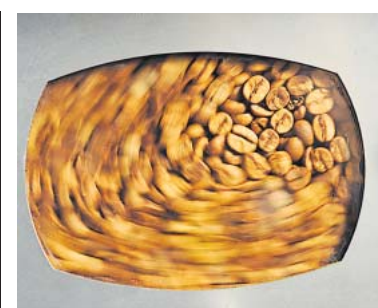
Sichtglas: Der Blick in die Rösttrommel hilft bei der Prozesssteuerung.
